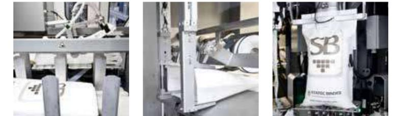
La ACROPAC es una máquina de ensacado totalmente automática con una capacidad de producción de hasta 600 sacos por hora. Por esta razón, esta máquina es ideal para todos aquellos que deseen pasar del ensacado manual/ semiautomático a un ensacado totalmente automático y/o que requieran una capacidad menor. Ya sean granulados plásticos, forrajes, fertilizantes o comida, la ACROPAC es ideal para el ensacado de productos a granel de flujo libre.
