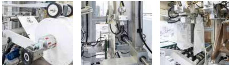
La SYSTEM-T, una máquina de ensacado FFS (form-fill-seal; forma-llenado-sellado) totalmente automática, combina un envasado de gran calidad en un saco de PE tubular con una gran capacidad de producción. Esto hace que sea ideal para su uso en distintas áreas como las industrias petroquímica, de los fertilizantes, de los forrajes y de los alimentos.
