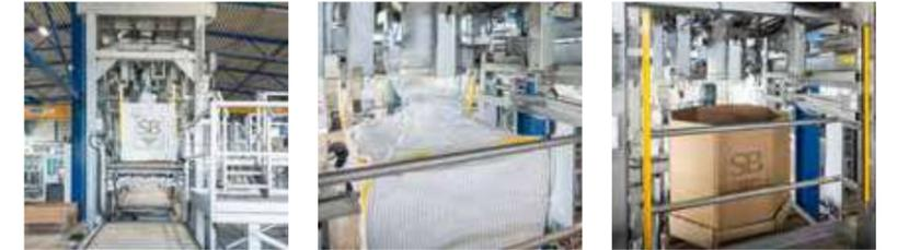
La estación de llenado de big bags semiautomática permite el llenado de Big Bags (FIBC) con una, dos o cuatro eslingas y cajas Octabin con un peso de llenado de 500 kg a 1500 kg.
