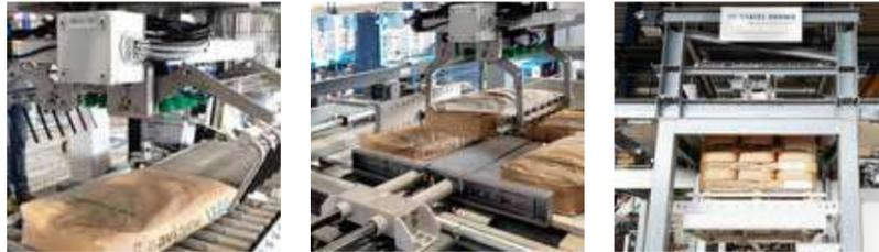
El PRINCIPAL-P, un portal paletizador de alto rendimiento, combina la alta velocidad del PRINCIPAL con un sistema de agarre adaptado a la correspondiente aplicación, p. ej. sistemas de agarre combinados para la paletización de sacos y cajas.
