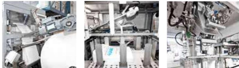
Como su propio nombre indica, la versión FFS-Combi de las máquinas de ensacado de sacos abiertos cuenta con un módulo FFS adicional, que permite no solo que se usen los sacos procedentes del depósito de sacos, sino también su producción a partir de film tubular. Las máquinas de ensacado de sacos abiertos CERTOPAC y PRINCIPAC están disponibles como versiones FFS-Combi. El módulo FFS adicional también está disponible para la cinta de ensacado CIRCUPAC.
