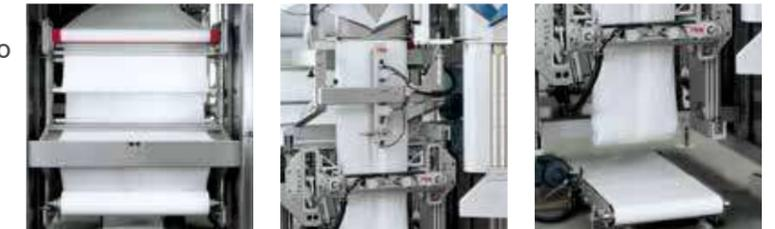
La System-F, una máquina de ensacado FFS (form-fill-seal; forma-llenado-sellado) vertical totalmente automática, produce sacos acolchados y sacos con fuelle lateral a partir de film plano. Además, se pueden fabricar los sacos con o sin asa de transporte y para un peso de llenado de entre 5 kg y 50 kg. La System-F es idónea para envasar productos en polvo y de flujo libre moderado.
