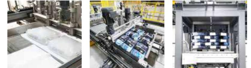
El robot paletizador de alto rendimiento PRINCIPAL-R, un sistema de paletización con brazo robótico articulado, se ofrece siempre como solución específica para el cliente con fabricantes de robots industriales de renombre y el know-how de STATEC BINDER. Según el rendimiento deseado se utilizan diferentes modelos de robots. El sistema de agarre también se adapta a la aplicación correspondiente. Una característica especial del PRINCIPAL-R es que se ha optimizado para sacos eslinga.
