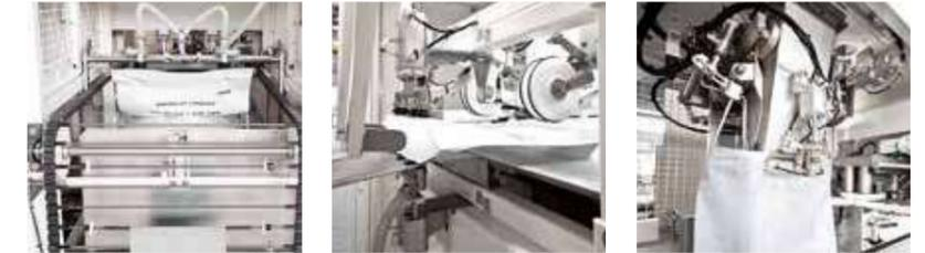
La máquina de ensacado de alto rendimiento totalmente automática CERTOPAC envasa cualquier tipo de producto a granel de flujo libre en sacos acolchados y sacos con fuelle lateral con un peso de llenado de entre 5 kg y 80 kg. Gracias a su alta velocidad, se pueden llenar hasta 1500 sacos por hora.
